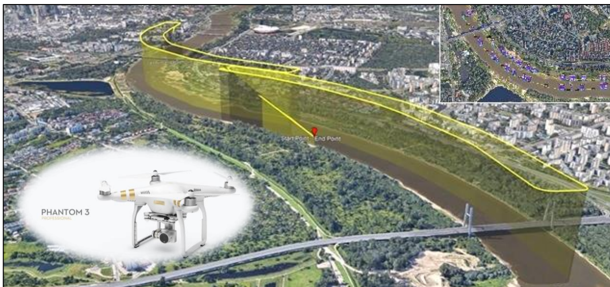
Rys. 32 Ścieżka przelotu autonomicznego w aplikacji Litchi oraz model wykorzystanego drona (DJI Phantom 3).
