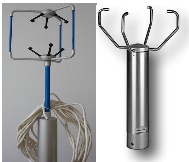
Rysunek 9.11 Anemometry ultradźwiękowe (źródło: archiwum Zakładu Meteorologii i Klimatologii SGGW oraz http://www.vaisala.com )
