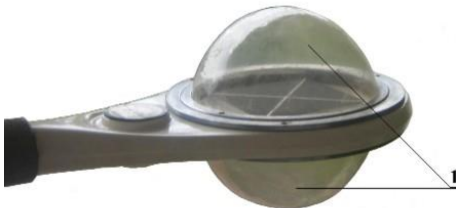
Rysunek 2.7 Pyrradiometr (bilansomierz): 1 - osłony z tworzywa sztucznego (źródło: http://www.kippzonen.com )
