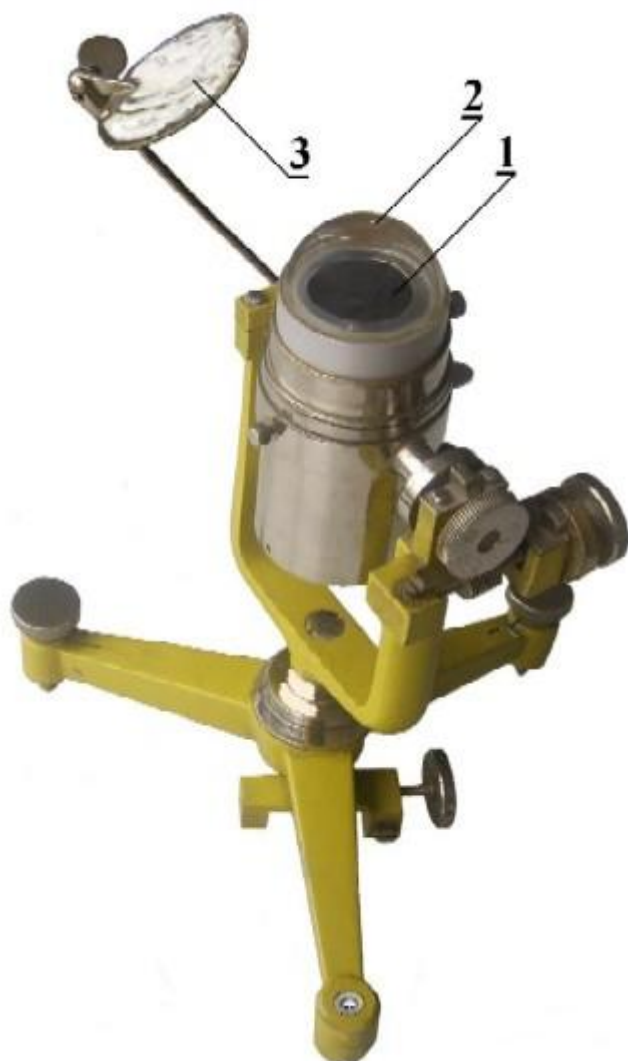
Rysunek 2.5 Pyranometr (solarymetr) Molla-Gorczyńskiego, pomiar promieniowania rozproszonego: 1 – powierzchnia termostosu, 2 - kopułka ochronna termostosu, 3 – ekran dyfuzyjny
